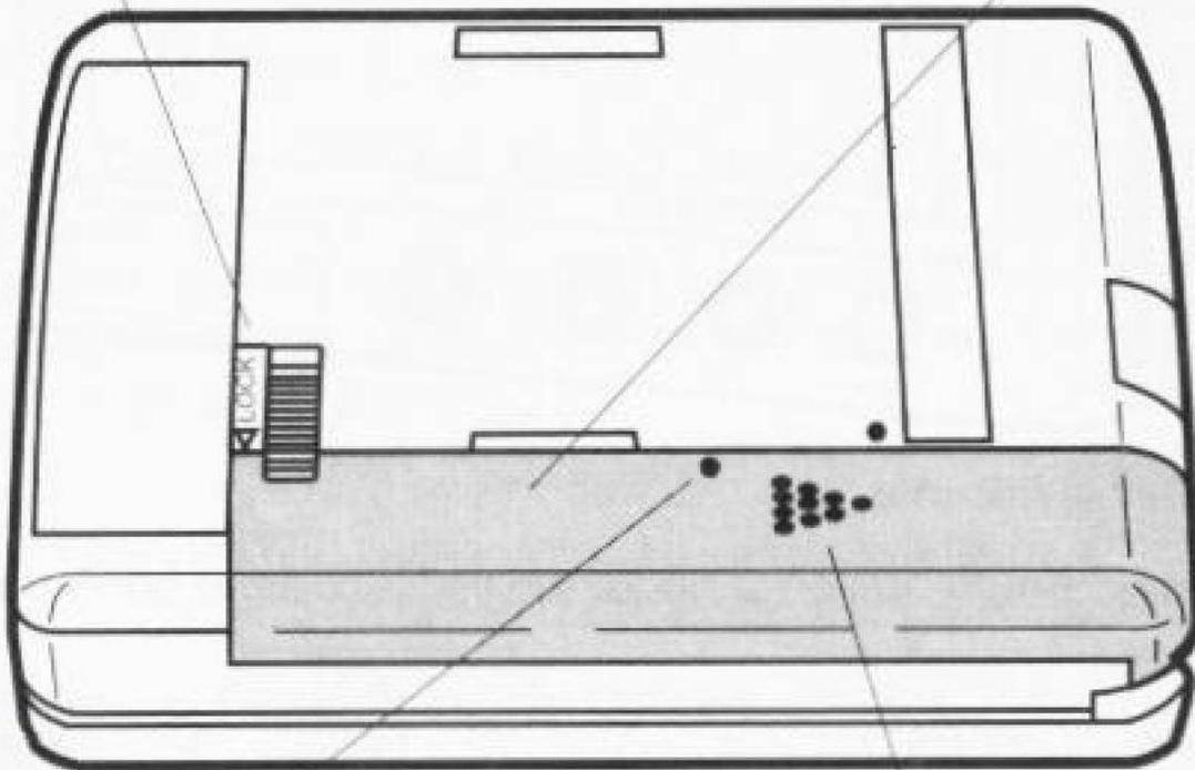
Markierung zum Schließen des Batteriefaches
